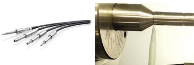
Abbildung 2: Beispiele Tastsonden und Prüfung Ventilgehäuse
